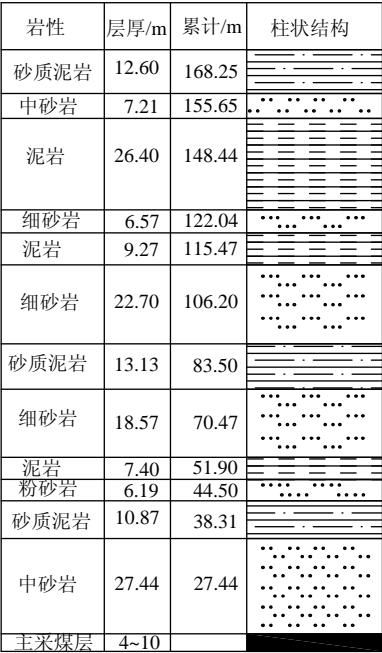
图 1 11201 工作面结构示意图
