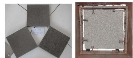
图 1 多孔泡沫铁镍金属材料 Fig.1 Porous bubble iron nickel metal material
