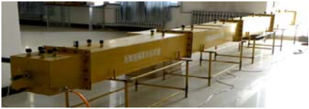
图 2 瓦斯爆炸实验管道 Fig.2 Gas pipeline explosion experiment pipeline
