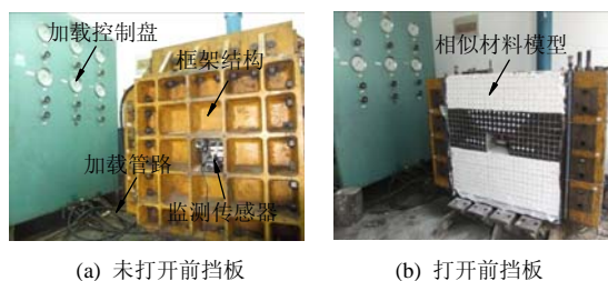
图 7 巷道平面应变相似模型
