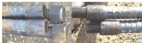
图 2 可接长锚杆连接处的结构组成
