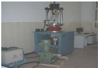
图 7 高温三轴实验机 Fig.7 The high temperature triaxial testing machine
