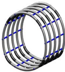
图 3 钢管混凝土支架连接方式 Fig.3 Connection method of STCC supports
