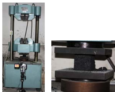
图2 煤样单轴压缩试验图
