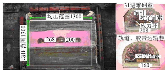
图 2 模型全貌及巷硐支护图 (mm)
