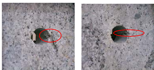
图 7 贯通裂缝
