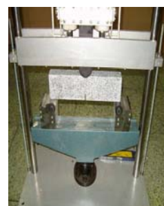
图 2 冲击加载装置
