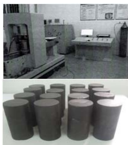
图 4 含瓦斯煤气固耦合试验系统及标准原煤试样
