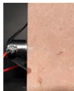
图 2 粉砂岩试件及声发射传感器安装
