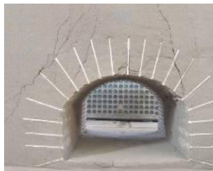
图3 锚固硐室模型试验剖面图
